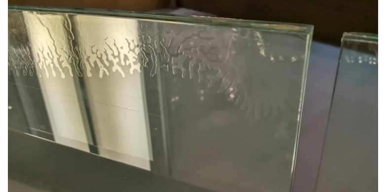
Miltä näyttää delaminoituminen
