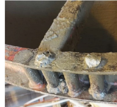
Valukuopan katkennut nostokorvake.
