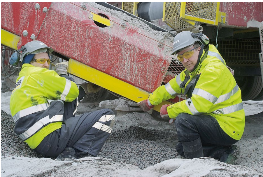
KUVA 1. Työntekijät käyttävät kaikkia tarvittavia henkilökohtaisia suojaimeja eivätkä ota riskiä työssään → kaksi oikein-havaintoa.
