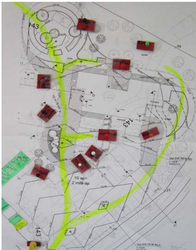
Kuva 19 Työmaan asemapiirros on kiinnitetty magneettien avulla työmaakopin metallisiin. Punaiset magneetit kuvaavat aluesuunnitelman liikkuvia elementtejä. Magneettien avulla suunnitelma on helppo päivittää.
