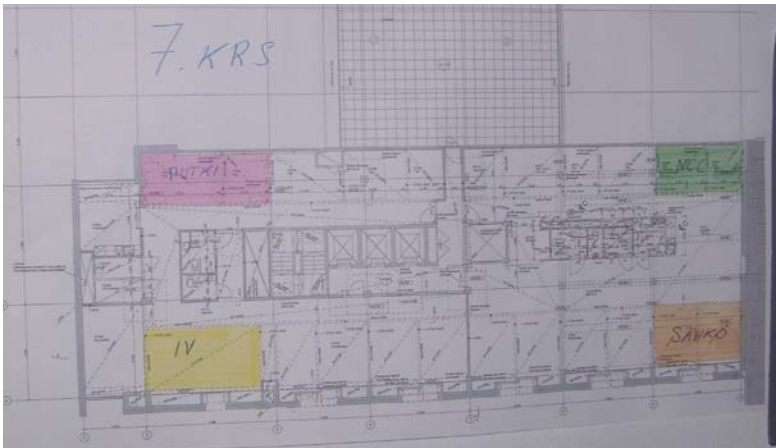
Kuva 15 Kerrokseen laitetaan näkyville esillä esimerkiksi pohjapiirrit, joissa esitetään mm. materiaalien varastointipaikat, oikeat ja turvalliset kulkureitit, ensiapupiste sekä uloskäynnit ja pelastusreitit.
