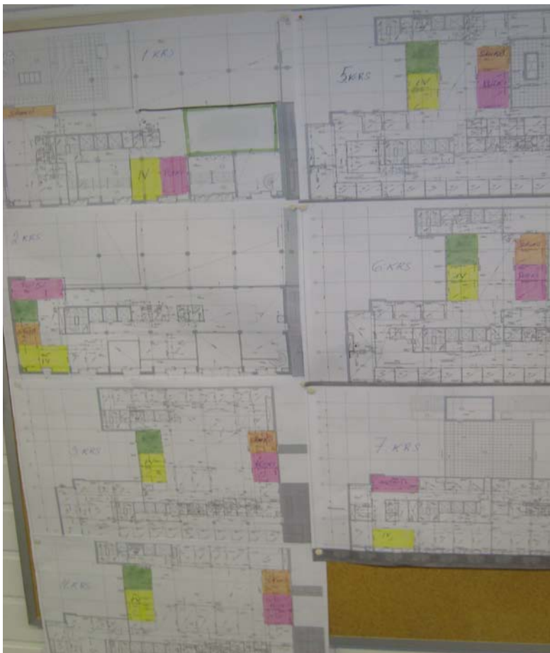
Kuva 34 Jokaiseen kerrokseen on merkitty kaikille urakoitsijoille omat varastointipaikat.
