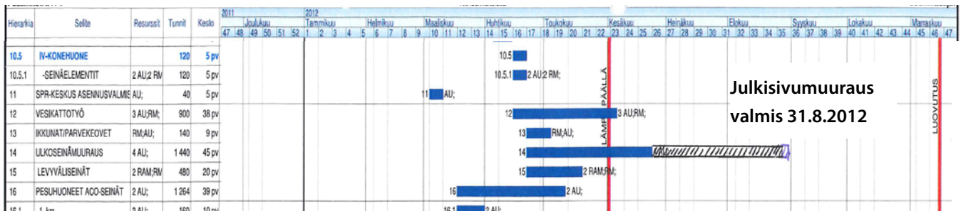
Kuva 39 Muuraustyön toteuminen on merkitty aikatauluun sekä jatkamalla viivaa että kirjoittamalla päättymispäivä.
