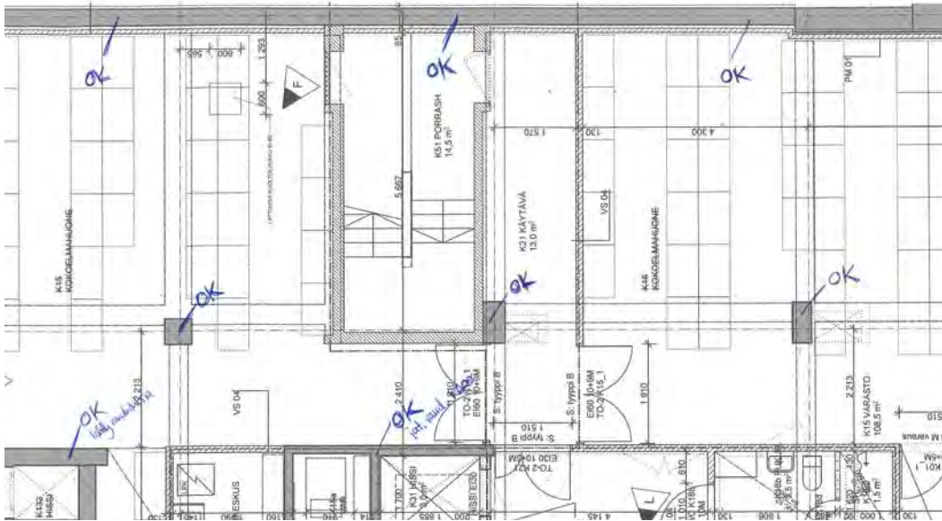
KUVA 42 Tarkastuksissa hyödynnetään olemassa olevia pohjia. Esimerkiksi raudoituksien tarkastukset voi merkitä pohjapiirustuksiin.
